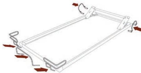
Die Matratzenhalter verhindern das Verrutschen der Matratze bei Bettgestellen, in denen die Matratze nicht tief genug einliegt. Bei Sitzrahmen verhindert bereits ein Matratzenhalter am Fußende das Verrutschen in Längsrichtung. Nachträglich montierbar. Bei allen Motorrahmen wird ein Matratzenhalter für das Fußende serienmäßig mitgeliefert.
